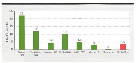
Bild 1 Entwicklung der Anforderungen an den Wärmebedarf (1975 - 2014).
