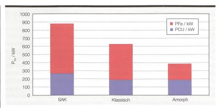
**Bild 3** Die Auswirkungen auf die Verlustleistung bei der SAK durch den Einsatz moderner Ortsnetztransformatoren.
