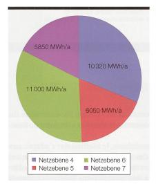
**Bild 1** Insbesondere in den Transformationsnetzebenen (NE 4 und 6) sind die Verluste hoch.
