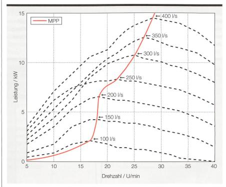
Leistungskurve der Steffturbine bei unterschiedlichen Wassermengen. Der Punkt maximaler Leistung (rote Linie) liegt bei unterschiedlichen Drehzahlen, deshalb ist ein drehzahlvariabler Betrieb notwendig, um diesen Punkt mit der Turbine anzufahren. Diese Daten wurden an der Testanlage der Universität der Bundeswehr München erzeugt.
