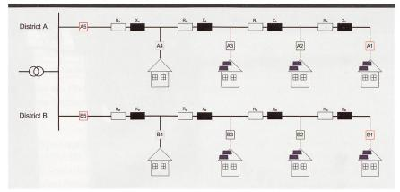
**Figure 1** Le réseau BT local est composé d'une ligne aérienne (District A) et d'un câble souterrain (District B) sur chacun desquels 3 installations photovoltaïques de différentes puissances ont été installées.
