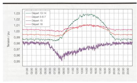
Figure 4 Tensions dans le réseau BT choisi sans réglage.
