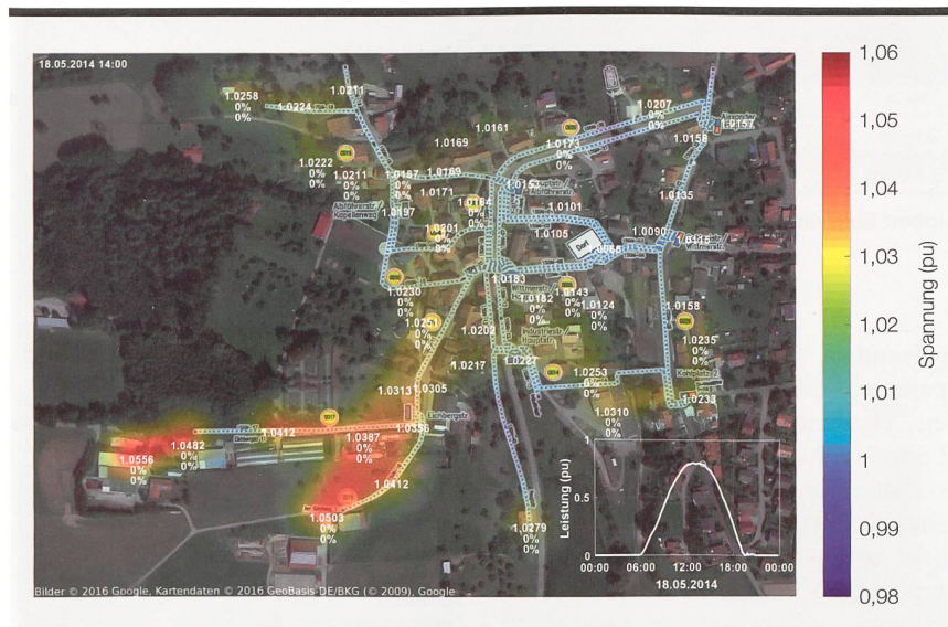
Bild 2 Im südwestlichen Teil des Niederspannungsnetzes in Dettighofen befinden sich zwei Stiehleitungen mit insgesamt 100 kW installierter PV-Leistung. An einem sehr klaren Sonntag um 14:00 Uhr (18.5.2014) entstehen an den Enden beider Stiehleitungen Spannungserhöhung von 5,0 % bzw. 5,6 %. Die erste Zahl und die Farben bedeuten die relative Spannung (pu-System) am entsprechenden Netzpunkt. Die Wirk- und Blindleistungsregelung ist inaktiv.
