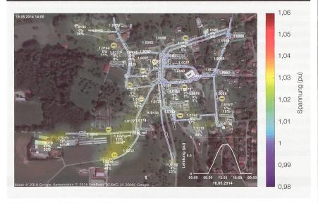
**Bild 3** Sobald die Wirk- und Blindleistungsregelung aktiv ist, kann die Spannungserhöhung an den Enden beider Stichleitungen auf 2,9 % bzw. 3,1 % begrenzt werden. Die erste Zahl in der Grafik bedeutet die relative Spannung an diesem Punkt. Die Zahlen darunter (nur bei Punkten mit PV-Anlagen) bedeuten prozentuale Abregelung der Wirkleistung gemessen an der aktuellen maximal möglichen Leistung (2. Zahl) und um wie viel Prozent die Blindleistungsregelung ausgeschöpft ist (3. Zahl).
