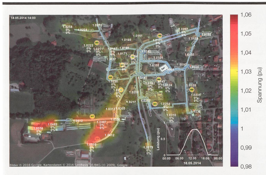
Bild 2 Im südwestlichen Teil des Niederspannungsnetzes in Dettighofen befinden sich zwei Sticleitungen mit insgesamt 100 kW installierter PV-Leistung. An einem sehr klaren Sonntag um 14:00 Uhr (18.5.2014) entstehen an den Enden beider Sticleitungen Spannungserhöhung von 5,0 % bzw. 5,6 %. Die erste Zahl und die Farben bedeuten die relative Spannung (pu-System) am entsprechenden Netzpunkt. Die Wirk- und Blindleistungsregelung ist inaktiv.
