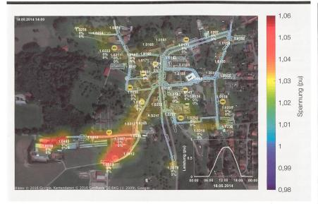
**Bild 2** Im südwestlichen Teil des Niederspannungsnetzes in Dettighofen befinden sich zwei Stichleitungen mit insgesamt 100 kW installierter PV-Leistung. An einem sehr klaren Sonntag um 14:00 Uhr (18.5.2014) entstehen an den Enden beider Stichleitungen Spannungserhöhung von 5,0 % bzw. 5,6 %. Die erste Zahl und die Farben bedeuten die relative Spannung (pu-System) am entsprechenden Netzpunkt. Die Wirk- und Blindleistungsregelung ist inaktiv.
