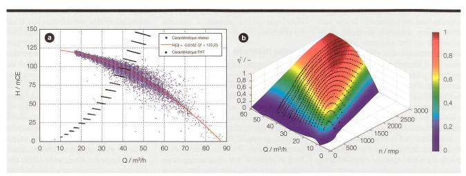
Figure 4 Caractéristiques H-Q de la PAT (noir) superposées à la caractéristique H-Q du site pilote (rouge) (a) et colline de rendement de la PAT en fonction du débit et de la vitesse de rotation (b).
