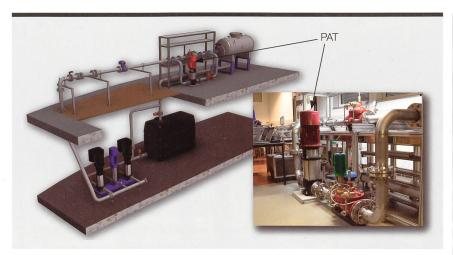
Figure 3 Implantation de la PAT sur le banc d'essai du Laboratoire hydraulique de la HES-SO Valais/Wallis.
