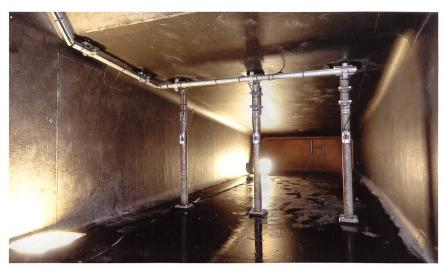
**Bild 1** Thermodynamische Niederdruckmessebene mit drei vertikalen Stangen und sechs innenliegenden Temperaturaufnehmern beim Saugrohraustritt im Hochdruckkraftwerk Filisur. CH.
