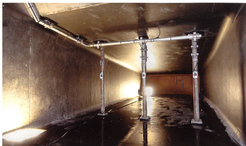
Bild 1 Thermodynamische Niederdruckmessebene mit drei vertikalen Stangen und sechs innenliegenden Temperaturlaufnehmern beim Saugrohraustritt im Hochdruckkraftwerk Filisur, CH.
