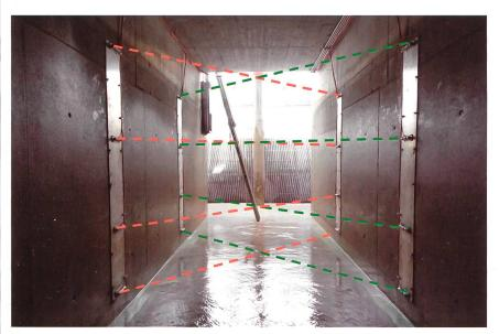
**Bild 3** Temporär montierte und mit einem Theodoliten ausgemessene 8-pfadige gekreuzte akustische Volumenstrommessung im Einlaufkanal des Dotierkraftwerks Pradella, CH.
