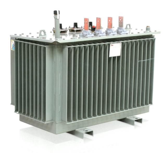
Die ABB-Verteiltransformatoren mit amorphem Kern sind eine extrem verlustarme Lösung. Die einzigartige Legierung des Kerns besteht aus Metallatomen, die in einem unregelmässigen Gitter angeordnet sind. Dadurch sinkt der magnetische Widerstand und verringert die Verlustleistung um bis zu 70 % im Gegensatz zu Kernen mit herkömmlichem Transformatorenblech. **abb.com**
