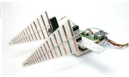
Radartechnik für eine Drohne zur präzisen Minensuche.
