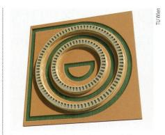
Der Laser mit Sensor besteht aus zwei Ringen mit einem Durchmesser unter 0,5 mm.
