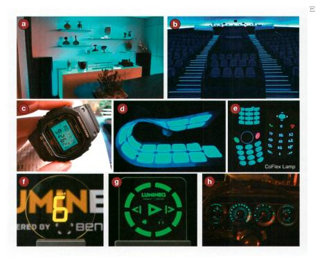
**Figure 1** Différentes applications de la technologie EL: illumination design (a), sécurité (b), rétroéclairage pour montres (c), claviers (d, e), afficheurs (f, q) et tableaux de bord pour voitures (h).
