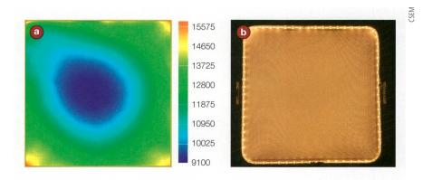
Figure 3 Module LED à éclairage périphérique (« edge-lit »): a) Distribution spatiale de la luminance mesurée sur la surface émettrice d'un panneau LED commercial. L'uniformité est de l'ordre de 55 % pour une variation de la température de couleur corrélée ΔCCT = 2186 K. b) Image de l'intérieur du panneau LED à éclairage périphérique testé.
