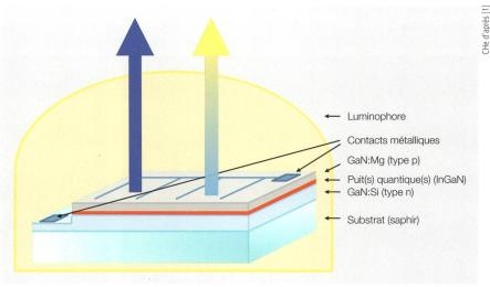
Figure 1 Structure d'une LED blanche.
