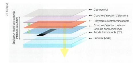
Figure 2 Structure simplifiée d'une OLED.
