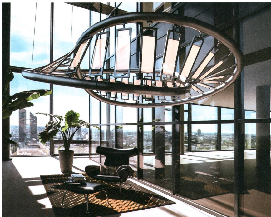
Figure 4 Le luminaire Rollercoaster a été réalisé, en 2012 déjà, en disposant 30 panneaux OLED transparents développés par Osram en suivant la configuration d'un ruban de Möbius.
