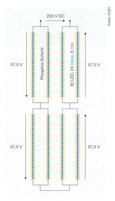
**Bild 2** Vereinfachtes Schaltschema einer Filament-Lampe: Die insgesamt acht Leuchtfäden sind paarweise in Serie geschaltet. Die Betriebsspannung beträgt 57,5 V Gleichstrom, was einen Gleichrichter im Schraubsockel bedingt. In dieser Konfiguration leuchten im Betrieb 240 LED.
