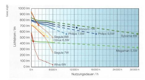
**Bild 4** Lichtstrom der 9 Filament-Lampen in Abhängigkeit der Nutzungsdauer. Die Werte über einer Nutzungsdauer von 6000 Betriebsstunden sind extrapoliert. Die fett markierten Punkte bezeichnen das Ende der Nutzungsdauer gemäss Prüfbedingungen: mindestens 70 % des deklarierten Lichtstroms während der Nutzungsdauer. Eine Falschdeklaration führt logischerweise zu einer Minderbewertung. Nur zwei Produkte erreichten die deklarierten Werte, die anderen sieben blieben unter den Erwartungen.
