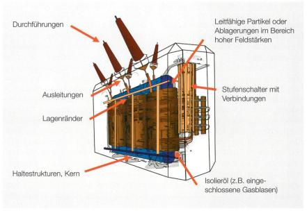
Bild 1 Häufige Teilentladungsquellen in Transformatoren.
