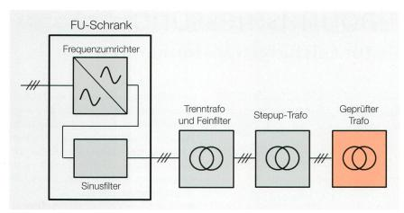
Bild 2 Prinzipschema einer Trafoprüfung mit Frequenzumrichter-Quelle.
