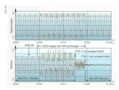
Bild 3 Strom und Spannung am Ausgang des ESR bei der Zuschaltung des ESR.
