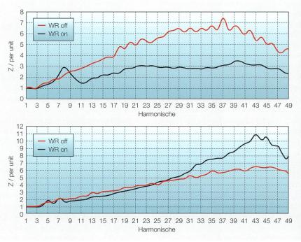
**Bild 1** Einfluss unterschiedlicher Wechselrichter-Typen auf die fNI in normierter Darstellung – oben: 5 String-WR, Hersteller A,  $S_n$  = 56 kVA, (Z@50 Hz WR off = 0,259  $\Omega$ , Z@50Hz WR on = 0,314  $\Omega$ ) – unten: 31 String-WR, Hersteller B,  $S_n$  = 930 kVA, (Z@50 Hz WR off = 0,059  $\Omega$ , Z@50Hz WR on = 0,064  $\Omega$ ).
