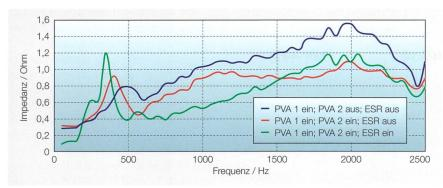
**Bild 2** Frequenzabhängige Netzimpedanz in Abhängigkeit der angeschlossenen PV-Anlagen (PVA 1 und PVA 2) und des lokal installierten Einzelstrangreglers (ESR).
