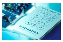
Die MoC-Technologie kann im Temperaturbereich von –40 bis +85 °C eingesetzt werden.
