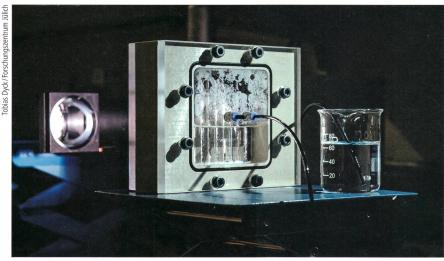
Testaufbau des Prototyps der fotoelektrochemischen Wasserspaltung.
