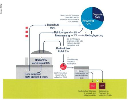
Bild 4 Massenbilanz. Ziel ist es, die als radioaktive Abfälle zu entsorgenden Massen zu minimieren.
