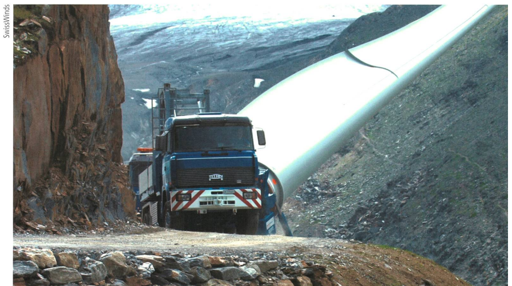
Bild 1 Transport eines Rotorflügels auf dem Griespass im Juli 2016.
