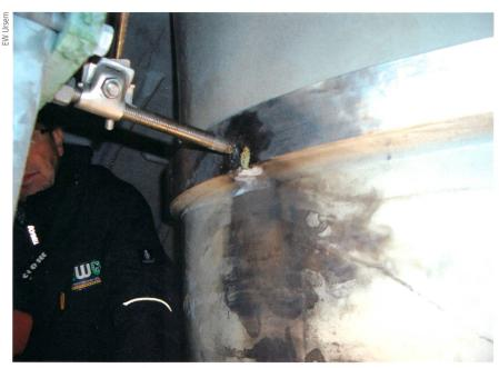
**Bild 5** Folgen eines Blitzeinschlags auf dem Schleifring des Rotorblatts einer Windanlage auf dem Gütsch bei Andermatt.
