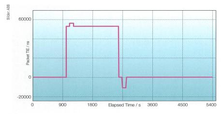
**Bild 8** Messung eines unidirektionalen Verzögerungssprungs des PTP-Stroms und die Wiederherstellung (53 μs) Kanalunterdrückungsschwelle.
