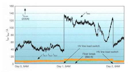
**Bild 7** Differenzialströme des Schutzrelais  $I_{dL1}$ ,  $I_{dL2}$ ,  $I_{dL3}$  und  $I_{Bias}$  über die Zeit.
