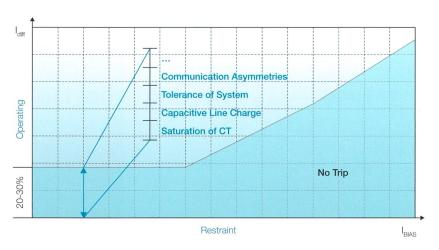
Bild 2 Auslösecharakteristik des Differenzialschutzrelais
