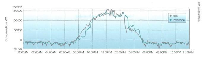
Figure 4 Modèle prévoyant la consommation d'énergie électrique d'une ville guotidiennement.
