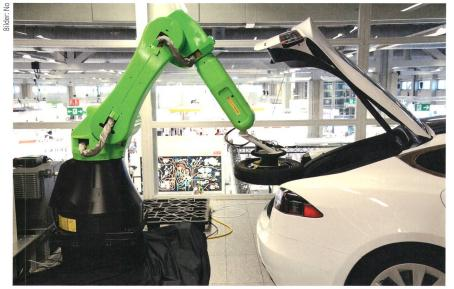
Kollaborative Roboter – Roboter, die in der Produktion direkt neben Menschen arbeiten können – gewinnen an Bedeutung. Dieser Roboter von Fanuc kann bis zu 35 kg präzise platzieren.
