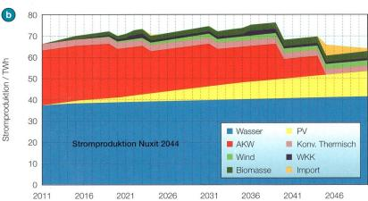
**Bild 1** Mögliche (ideale) Szenarien für den Ersatz von Nuklearstrom, für die beiden Varianten: Nuxit 2029 und Nuxit 2044.
