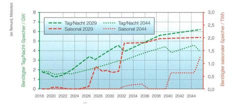
**Bild 2** Benötigter Ausbau von Pumpspeichern (Tag/Nacht-Ausgleich, grün) und von Speicherseen (saisonaler Ausgleich, rot), nach unseren Szenarien (Nuxit 2029 und 2044).
