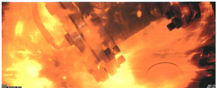
Bild 4 Ein nicht konformes Gerät führt zu einer Zündung der Gase im Druckkessel.
