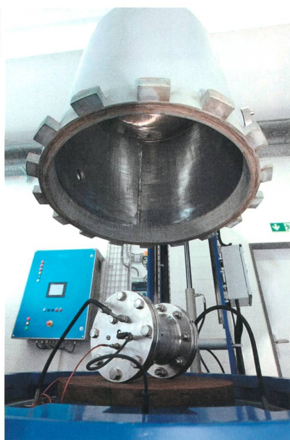
Bild 3 Beispiel eines Prüfmusters «druckfeste Kapselung».
