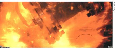
Bild 4 Ein nicht konformes Gerät führt zu einer Zündung der Gase im Druckkessel.
