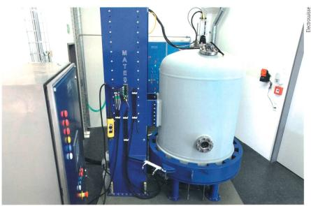
**Bild 1** Prüfeinrichtung «druckfeste Kapselung».
