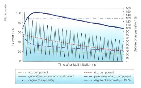
**Bild 6** Asymmetrischer Fehlerstrom bei einem generatorgespeisten Kurzschluss mit fehlenden Nulldurchgängen. Grad der Asymmetrie (degree of asymmetry):  $a = I_{dc} / (\sqrt{2} I_{ac})$ , im vorliegenden Fall a = 148% (nach IEC/IEEE 62271-37-013, Figure H.1).
