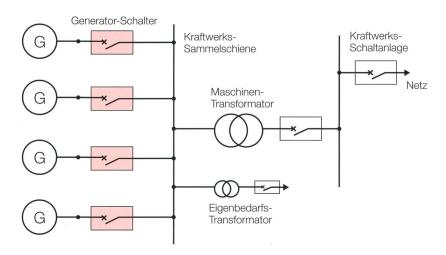
Bild 2 Schaltungskonzept mit Kraftwerks-Sammelschiene.
