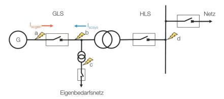
**Bild 4** Schaltungskonzept mit Generator-Leistungsschalter (GLS-Konzept). Fehlerorte für die Auslegung im Kurzschlussfall: (a) Netzgespeister Kurzschluss I<sub>scsys</sub> (system-source short-circuit current), (b) Generatorgespeister Kurzschluss I<sub>scgen</sub> (generator-source short-circuit current), (c) Kurzschluss nach Eigenbedarfstransformator, (d) Kurzschluss an der Hochspannungs-Sammelschiene des Kraftwerks.
