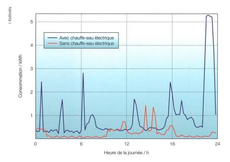
**Figure 4** Comparaison de la courbe de charge de deux foyers individuels, l'un avec un chauffe-eau électrique (bleu), l'autre sans (rouge). Le chauffe-eau est clairement actif le soir lorsque le tarif du courant est meilleur marché.
