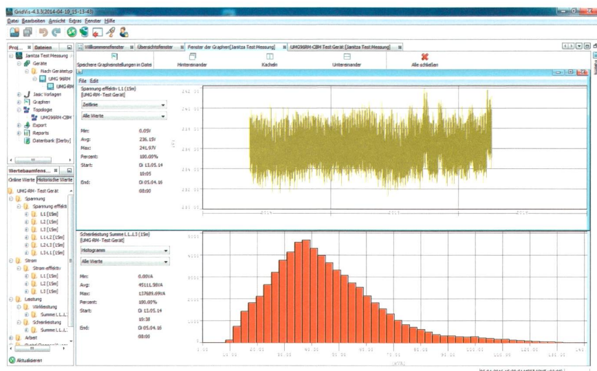
Bild 3 Mit dem Universalmessgerät in der Niederspannungs-Verteilung (NSV) kann der Lastgang des Transformators (Kategorie 2) ausgewertet werden.
