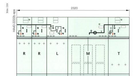
**Bild 4** Mögliche MS-Schaltanlage von einer Übergabestelle mit Leistungsschalterabzweig, Feld L (Kategorie 4).
