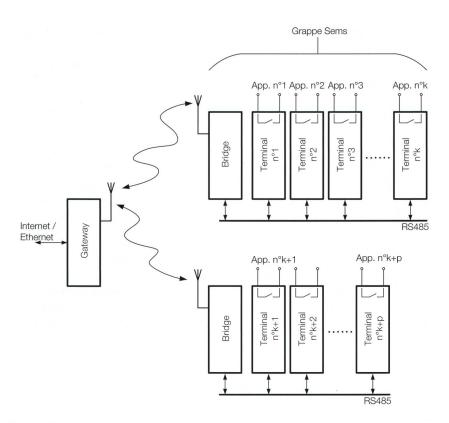
Figure 4 Synoptique de l'installation des modules Sems.
