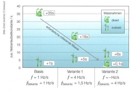
**Bild 5** Zusätzlich erforderliche Netzanlaufzeitkonstanten zur Einhaltung der Frequenzgradienten.
