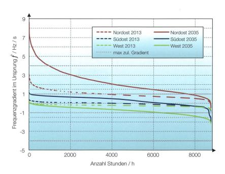
**Bild 3** Dauerlinie des Frequenzgradienten beim Störungseintritt. [2]
