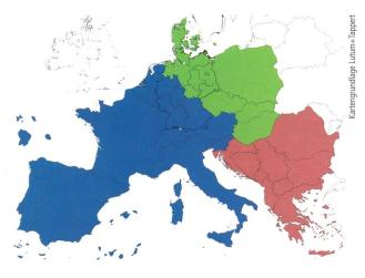
**Bild 2** System-Split-Szenario, 3-Zonen-Störung angelehnt an E.ON-Störung 2006.[2]
