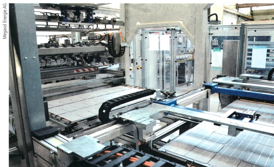
Vollautomatisches Lay-up in der Solarmodul-Produktion in Deitingen.
