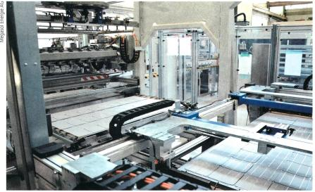
Vollautomatisches Lay-up in der Solarmodul-Produktion in Deitingen.
