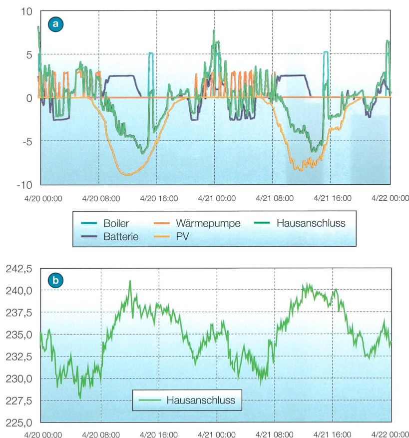
Bild 4 Gemessene Leistungen in Kilowatt (oben) und Spannung in Volt (unten) im Haus HH1.
