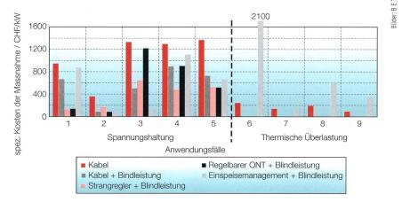
**Bild 3** Spezifische Kosten innovativer Technologien bei unterschiedlichen Anwendungsfällen <sup>1)</sup> zur Integration dezentraler Erzeugung in die Verteilnetze [2].
