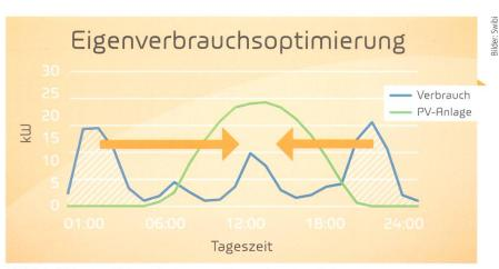
**Bild 3** Zeitliche Verschiebung der Lasten zur Eigenverbrauchsoptimierung.
