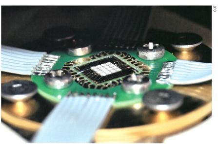
**Bild 3** Mit LED können Bestrahlungsstärken von über 80 W/cm² erreicht werden. Dies ist mit anderen Strahlungsquellen kaum erreichbar.
