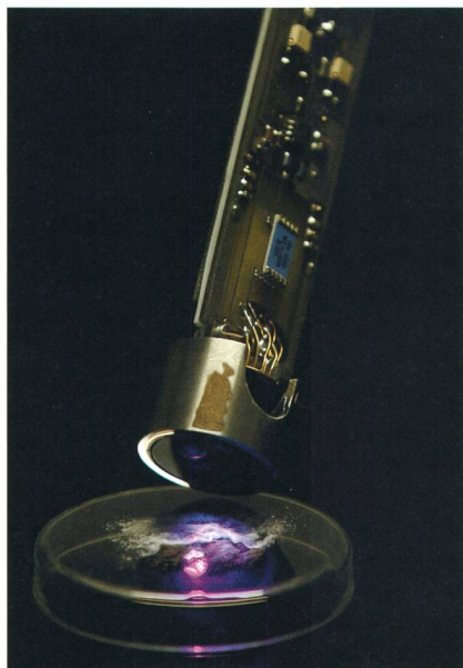
Bild 4 Lebensmittelüberwachung mit Fluoreszenzanalyse bei 280 nm. Viele organische Substanzen wie beispielsweise Proteine zeigen eine deutliche Fluoreszenz.
