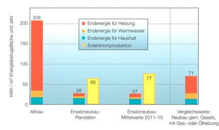
**Bild 2** Der Ersatzneubau senkt den Energieverbrauch um 87 % und produziert rund dreimal mehr Solarstrom, als verbraucht wird.
