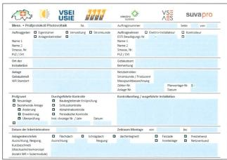
**Bild 4** Mess- und Prüfprotokoll nach SN EN 62446.
