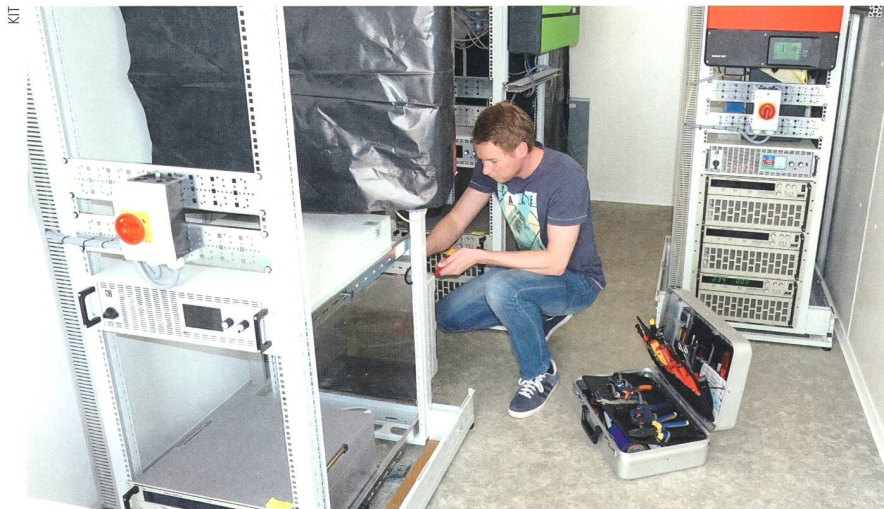
Teststände am KIT, mit denen über 20 kommerzielle Heimspeicher für PV-Strom analysiert werden.
