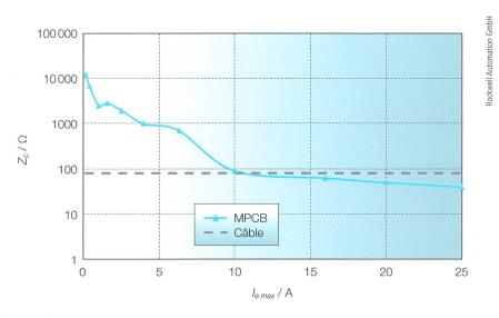
**Figure 5** Impédance caractéristique  $Z_c$  de la bobine de déclenchement magnétique d'un MPCB.
