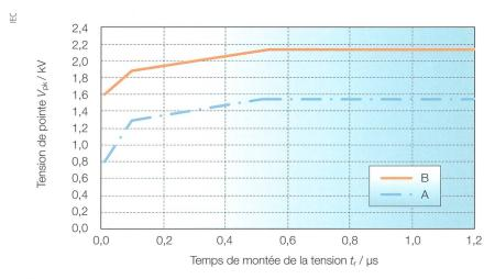
**Figure 4** Enveloppe des tensions d'impulsions  $V_{pk}$  autorisées aux bornes d'une machine en fonction de la durée de l'impulsion  $t_r$  jusqu'à 500  $V_{AC}$  (courbe A) et de 500 à 690  $V_{AC}$  (courbe B), selon IEC TS60034-25 [14].
