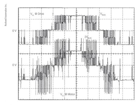
Figure 2 Tensions PWM aux bornes du variateur et du moteur [4].
