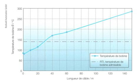
**Figure 9** Température  $\theta$  de la bobine de déclenchement en fonction de la longueur de câble pour une fréquence  $f_o = 4$  kHz.
