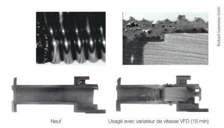
Figure 8 Isolation de bobine endommagée et support de bobine fondu.
