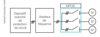
**Figure 1** Groupe de moteurs gérés par un variateur unique.
