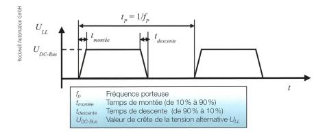
**Figure 3** Caractéristiques temporelles d'une séquence d'impulsions à tension continue générées par un variateur de vitesse.
