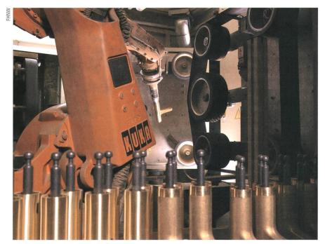
Bild 2 KWC-Roboterschleifzelle.
