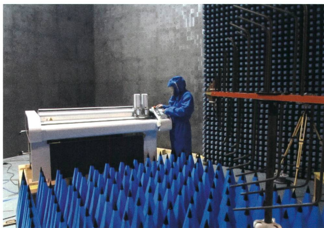
Bild 1 Es kommt oft vor, dass ein Gerät bei der EMV-Prüfung (bis 20 V/m) bedient oder direkt überwacht werden muss.
