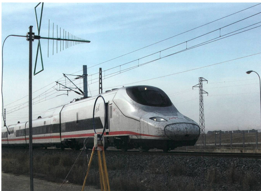
Figure 4 Mesures des émissions rayonnées d'un train Talgo.
