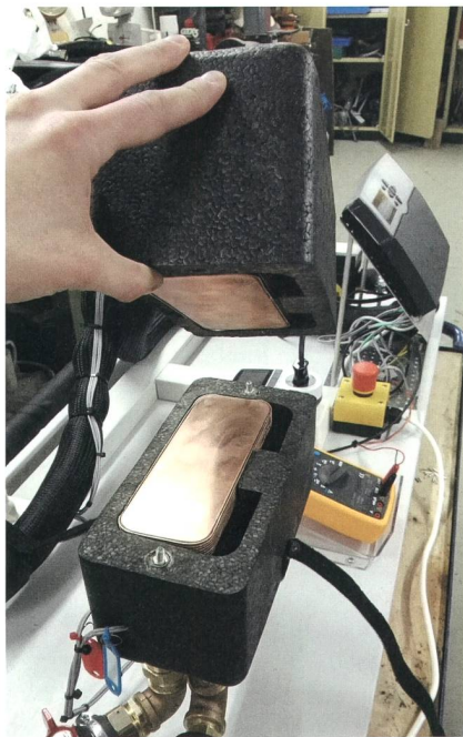
Demonstrator mit 1 kW thermischer Übertragungsleistung, wie er im Kontext mit der BFE-Studie zur Thermoelektrik gebaut wurde. Im Bild: Geteilter Wärmetauscher zur Aufnahme eines thermoelektrischen Elements.
