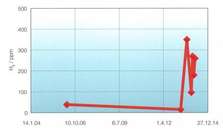
Bild 3 Plötzlicher Anstieg von Wasserstoff im Öl durch Teilentladungen.
