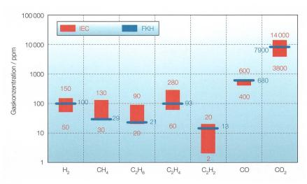
**Bild 1** Typische Fehlergaskonzentrationen Schweizer Transformatoren (FKH) im Vergleich zu internationalen Daten (IEC).
