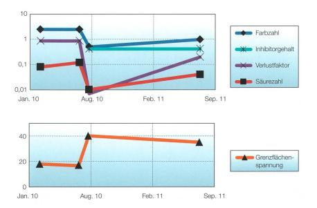
Bild 2 Zustand des Isolieröls vor und nach einer Aufbereitung durch Fullerung.
