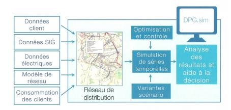
Figure 5 Structure de la plate-forme de simulation DPG.sim.
