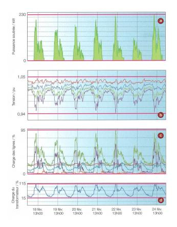
Figure 2 Scénario « Forte consommation des voitures électriques » : exemple d'une semaine hivernale typique (18 au 24 février). a) Consommation des voitures électriques, b) Bande de tension, c) Charge des lignes électriques, d) Charge des transformateurs.
