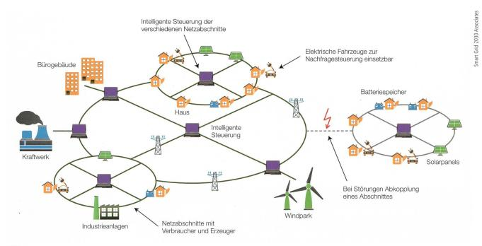
**Bild 1** Schematische Darstellung eines Smart Grids.
