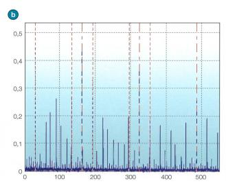
Bild 1 a) Vibrationssignal im Zeitbereich 0-500 ms, b) FFT der Hüllkurve von (a) im Frequenzbereich 0-550 Hz.
