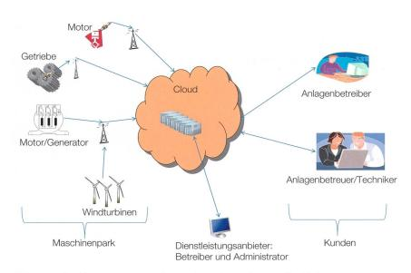
Bild 2 Eine cloud-basierte automatische Maschinenüberwachung im Überblick.
