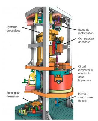
Figure 5 Représentation schématique de la balance du watt « BWM II » de Metas.
