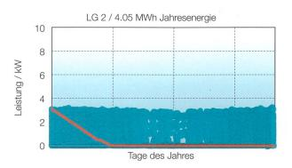
Bild 5 Vergleich von zwei Kunden mit gleicher Jahresenergiemenge, aber sehr unterschiedlichen Leistungsbezügen (blau) mit Jahresdauerlinie (rot).
