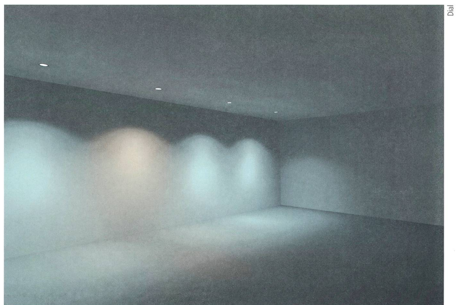
Farbortverschiebung bei LEDs.
