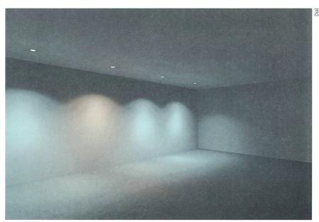
Farbortverschiebung bei LEDs.
