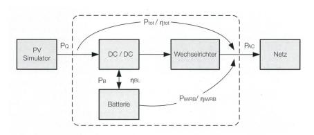
Bild 4 Betriebsmodi und deren Wirkungsgrade.
