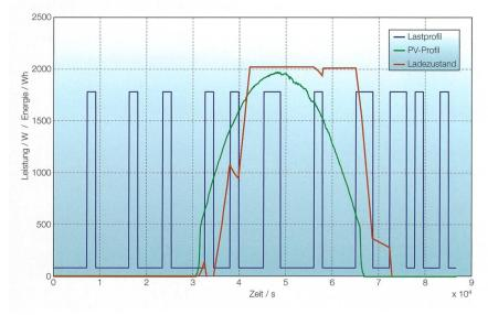
Bild 3 PV-Profil und Lastprofil 1 mit theoretischem Speicherfüllstand.
