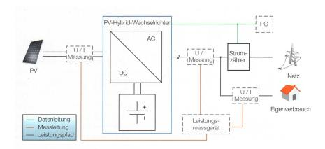
**Bild 2** Übersichtsdiagramm des Messaufbaus für die Gesamtenergiebilanz.
