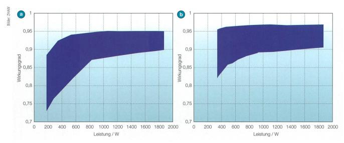
**Bild 5** Wirkungsgradbereiche für Batterieladung ab PV (a) und Batteriewechselrichter (b).
