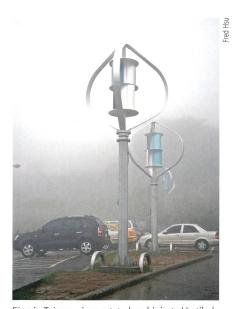
Eine in Taiwan eingesetzte kombinierte Vertikalachsen-Turbine mit Darrieus- (aussen) und Savonius-Turbine (innen). Erstere nutzt das dynamische Auftriebsprinzip, letztere den Luftwiderstand.
