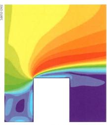
Durch die Strömungsabhebung an der Gebäudekante können die Windgeschwindigkeiten über der Strömungsblase um 20% höher liegen.
