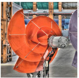
In den Niederlanden wird dem Thema urbane Kleinwindkraft kreativ begegnet: Die Liam F1 Turbine von The Archimedes BV soll laut Hersteller 1,5 kW bei einer Windgeschwindigkeit von 15 ms<sup>-1</sup> liefern.
